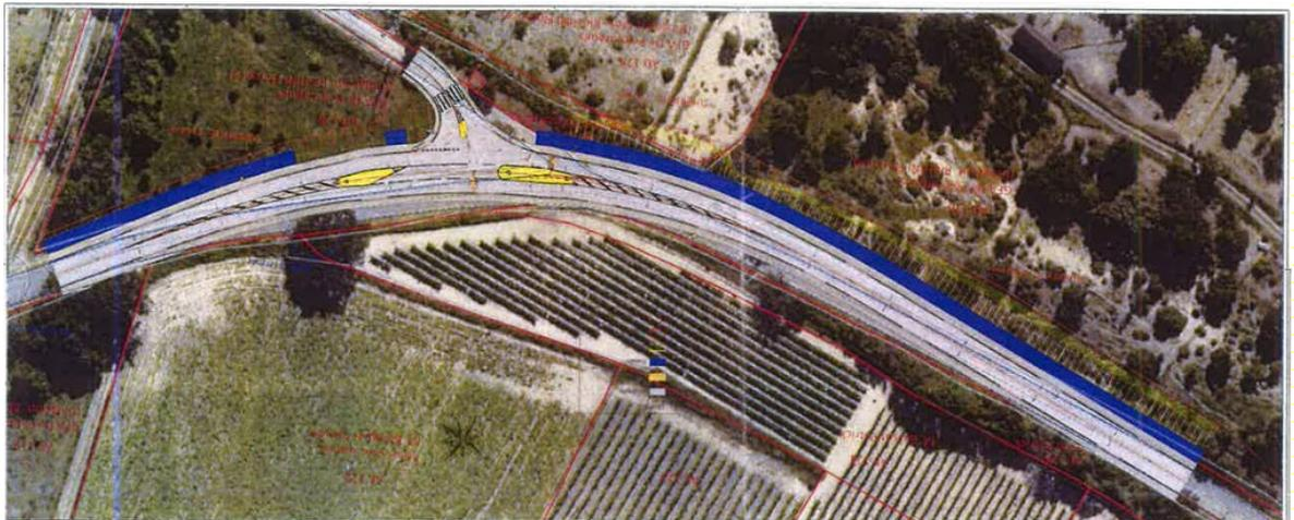
Les travaux consistent à réduire les rayons de courbure de la voirie au croisement de la RD35 et du chemin de Campagnani pour améliorer la visibilité et donc la sécurité. Ces travaux comprennent aussi un aménagement de sortie de ce chemin sur la D35 avec bornes de séparation. Ces travaux doivent commencer en septembre 2023 supervisés par l'UT30 d'Alès.
